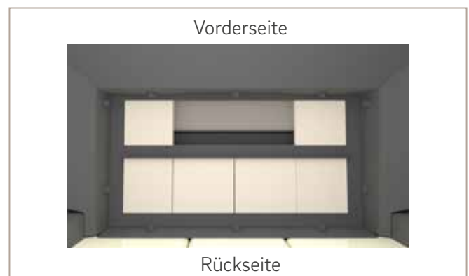
Abb. 37: Umlenkplatten innen einsetzen - schematische Darstellung. Ansicht von unten durch den Feuerraum Richtung Abgassammler
