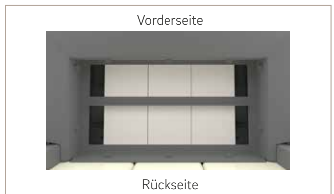
Abb. 47: 3 Umlenplatten mittig ausrichten - schematische Darstellung. Ansicht von unten durch den Feuerraum Richtung Abgassammler
