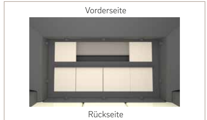
Abb. 40: Umlenkplatten Ebene 1 entnehmen - schematische Darstellung. Ansicht von unten durch den Feuerraum Richtung Abgassammler
