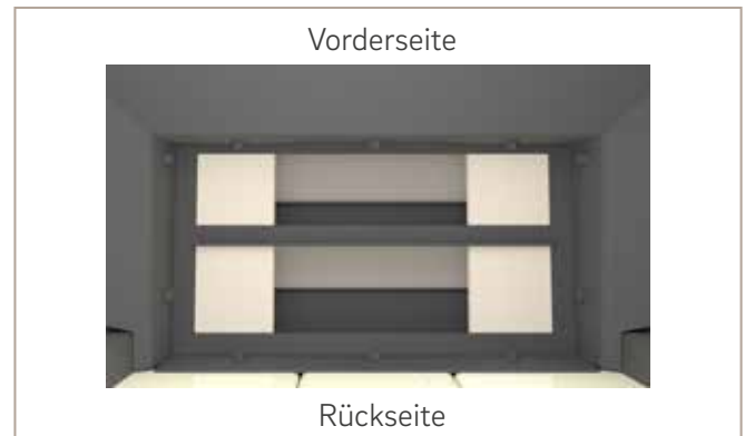
Abb. 36: Umlenkplatten außen einsetzen - schematische Darstellung. Ansicht von unten durch den Feuerraum Richtung Abgassammler
