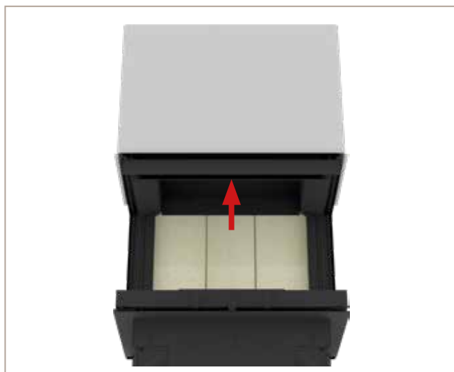
Abb. 39: Umlenk- und Katalysatorplatten durch den Feuerraum einsetzen
