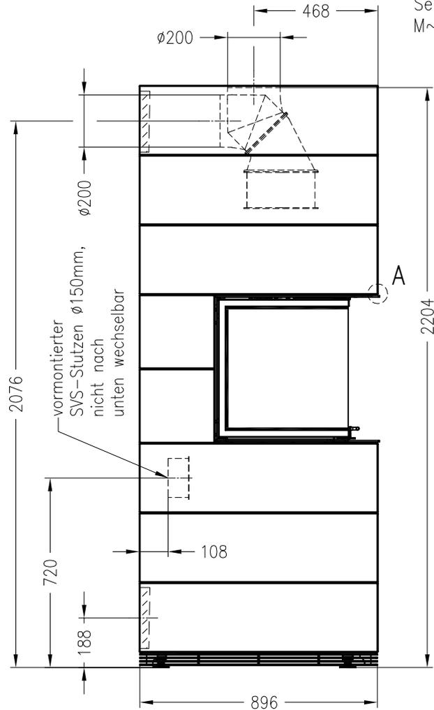
in Betonelement zu erstellender Ausbruch für Abgas- und optionalen Verbrennungsluftanschluss hinten
