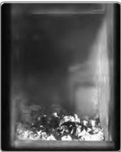
Haben Sie zusätzlichen Wärmebedarf, legen Sie einmalig 2 Scheite Brennholz nach, solange noch ausreichend Grundglut vorhanden ist. Verteilen Sie beim Auflegen oder Nachlegen von Brennholz allfällig vorhandene Restkohle gleichmässig mit einem Schürhaken.
