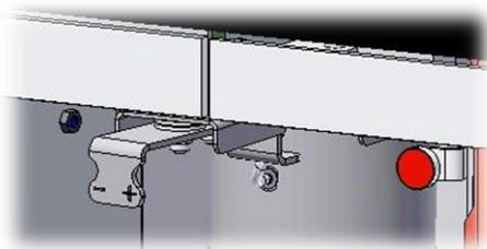
Ist der Holzabbrand vollständig erfolgt und die Flamme gänzlich erloschen, so stellen Sie den Verbrennungsluftschieber auf das „Symbol –“ und schließen somit die Luftzufuhr.
