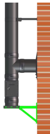
Bild 5-4: Aufbau Grundplatte mit Kondensatablauf und Wandstütze „schenkelabwärts“
