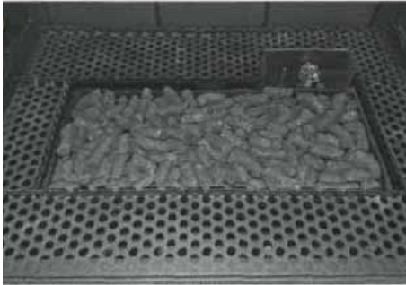
Abb. 2.10 Einlegen der Chips auf das Brennerbett.
