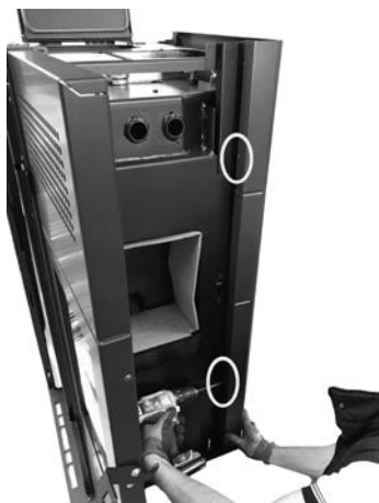
Fig. 59 - Vordere Befestigung des Seitenteils
