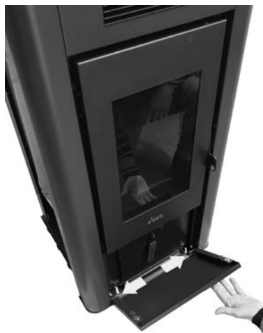
Fig. 26 - Einsetzen der unteren Tür
