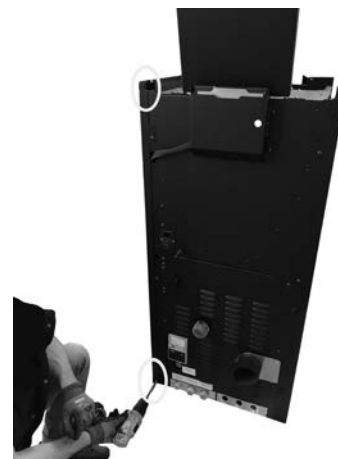
Fig. 60 - Hintere Befestigung des Seitenteils
