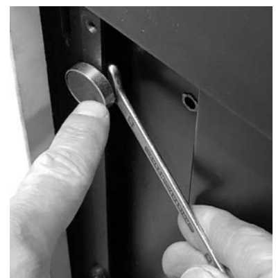
Fig. 41 - Den Magneten einstellen und mit dem Schlüssel festziehen
