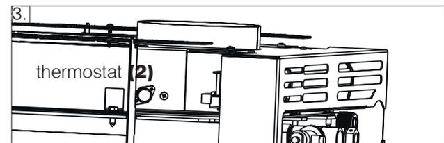
4. Den Thermostat, den Ventilator und die Stromversorgung gemäß den Vorgaben im Schaltplan anschließen. Den Kabelstrang durch das Langloch in der Rückwand des Heizofens führen.
