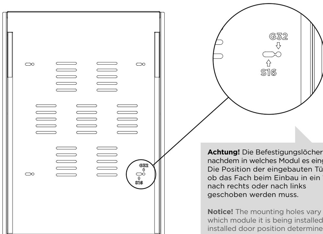
**Achtung!** Die Befestigungslöcher variieren, je nachdem in welches Modul es eingebaut wird. Die Position der eingebauten Tür bestimmt, ob das Fach beim Einbau in ein 16er-Modul nach rechts oder nach links geschoben werden muss.
