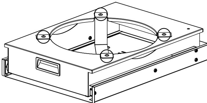
**Hinweis!** Für die Verwendung mit der Gasflaschenwaage tauschst du einfach den Flaschenkorb aus, indem du die vier Schrauben löst und ihn abnimmst. Achte darauf, dass das Kabel richtig zur Rückseite des Schrankes geführt wird und befestige es mit dem Kabelbinder an der Schublade.
