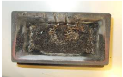
BEISPIEL VERSCHMUTZTE BRENNSCHALE
