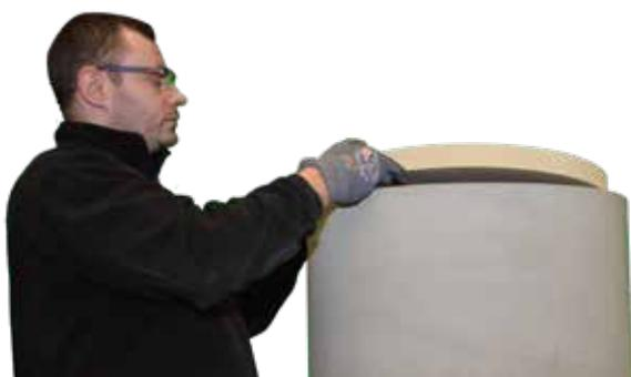
55. Alle Teile mit Acrylkleber neu setzen und die Innen-Deckenplatte (40 mm Vermiculite) von oben in die Anlage einlegen .
