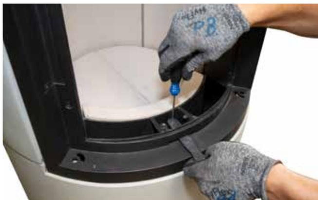
58. Luftstellhebel bei den Schrauben wieder montieren.
