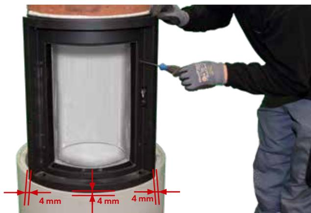
22. Türzarge wieder an vorgegebener Position mit Schraube M 6 x 10 montieren und Korpus gleichmäßig ausrichten.
