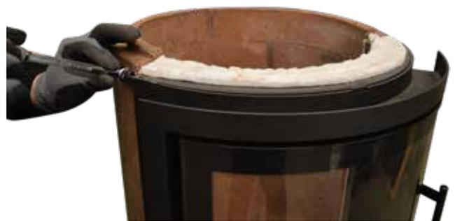
6. Schamottehaltering auf beiden Seiten mit 10 mm Schraubenschlüssel demontieren und die Schamotte Aussenhülle zur Seite legen!
