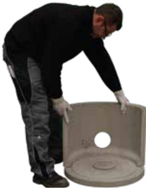
3. Hinteres Unterbauteil **ohne zu verkleben** auf die Bodenplatte setzen.
