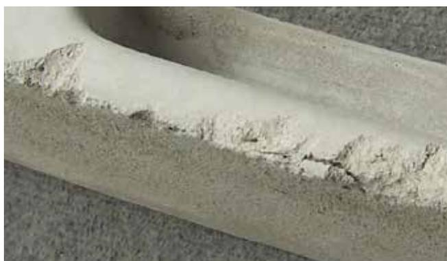
Die Speicherbetonverkleidung ist mit einer Armierung versehen und hat daher eine sehr hohe Stabilität!
