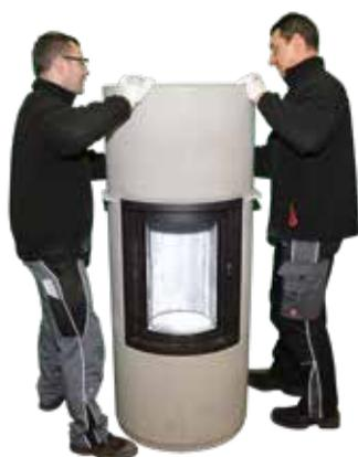
29. Zur Montageerleichterung bitte aus den Verpackungstreifen der Anlage an vier Stellen die Streifen auflegen und Oberbauteil **ohne zu verkleben** auf die Seitenteile setzen. Montageerleichterung wieder entfernen.
