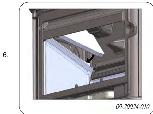
Vermiculit-Flammplatte R oben 03.77713.000
