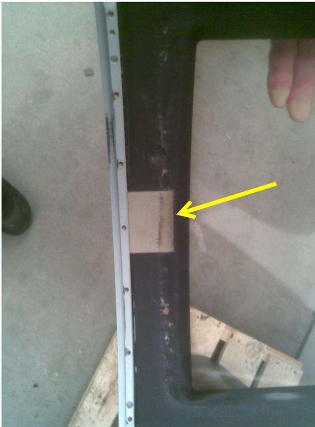
Wenn notwendig, die alte Dichtung durch eine neue ersetzen. Sichern, dass die Dichtung korrekt montiert wird, damit die Tür dicht ist.
