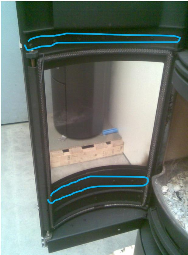
Bei Demontage der Aluleiste, bitte notieren wie die Silikone-Profilleiste kehrt. Sie muss in der gleichen Weise wieder montiert werden.
