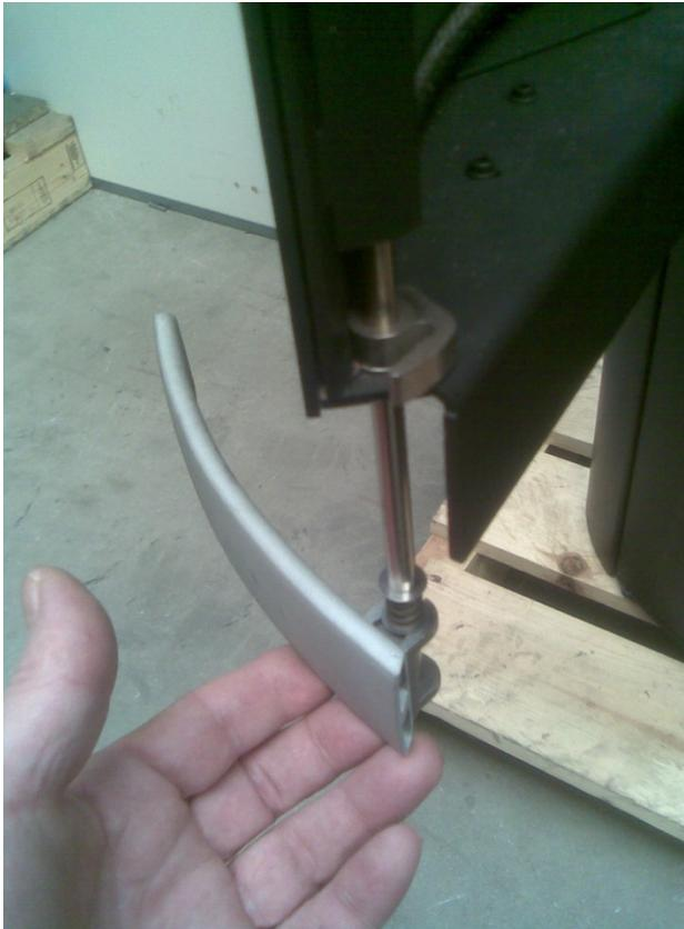
**Die Schraube hinter der Achse kann jetzt mittels eines 2,5 mm Inbusschlüssels abmontiert werden.**
