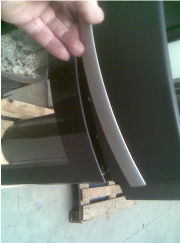
**Die Aluleisten leicht drücken, damit es einfacher wird, die Schrauben wieder zu montieren.**
