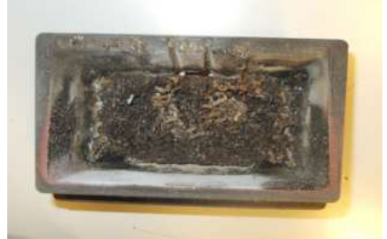
BEISPIEL VERSCHMUTZTE BRENNSCHALE
