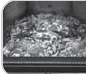
De eindfase van de verbranding is bereikt, als het hout volledig is afgebrand, geen smeulend vuur of een niet volledige verbranding kan ontstaan. Nu kan de stelhendel worden gesloten (linker positie).
