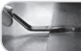
8а. Для этого переведите регулировочный рычаг приблизительно в среднее положение (первичный воздух закрыт). Если теперь огонь горит очень слабо, откройте заслонку немного шире, передвигая регулировочный рычаг вправо (в направлении «+»).
