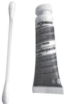
La pâte de graissage s'applique pour éliminer les portes qui se ferment difficilement ou les bruits qui sont générés à la fermeture ou à l'ouverture de la porte du poêle. La pâte à graisser doit être appliquée au moins une fois par an sur le raccord à ressort du SmartClose et sur ses galets.
