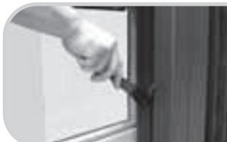
Die „Kalte Hand“ seitlich rechts der Tür auf die Aufnahme/Verschluss aufsetzen und nach oben drehen.
