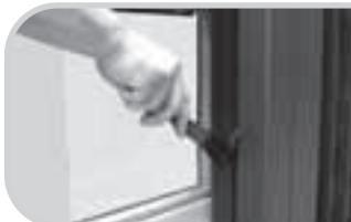
De „koude hand“ aan de zijkant rechts vande deur op de bevestiging/sluiting aanbrengen en naar boven draaien.
