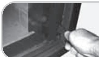
1. Die „Kalte Hand“ seitlich im unteren Bereich, auf der rechten Seite der Tür, auf die Aufnahme aufsetzen.
