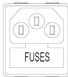
Fig. 28 - Abdeckklappe mit Sicherungen, die ausgewechselt werden müssen
