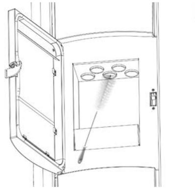
Fig. 27 - Reinigung der Rohrbündel
