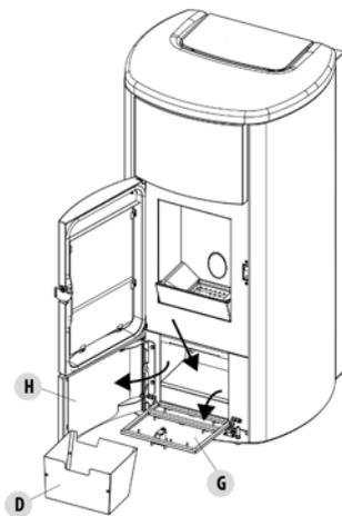
**Fig. 24 - Entnahme Aschenlade**
