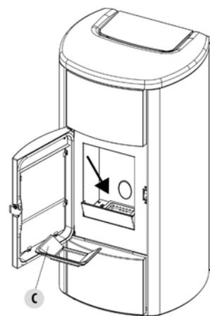
**Fig. 25 - Entnahme Brennschale**
