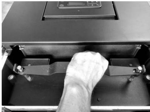
*Fig. 26 - Hebel für die Reinigung der Rohrleitungen*
