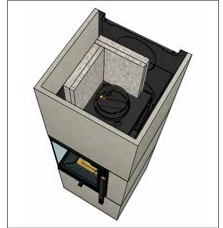
Vier Speicherplatten wie abgebildet positionieren.
