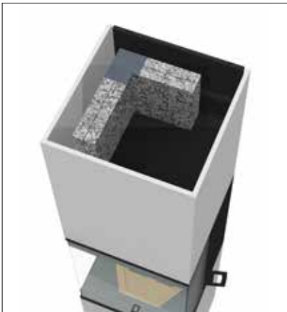
Speicherplatten mit einem Eckwinkel sichern.
