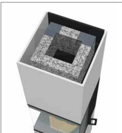
Die letzten Speicherplatten positionieren.
