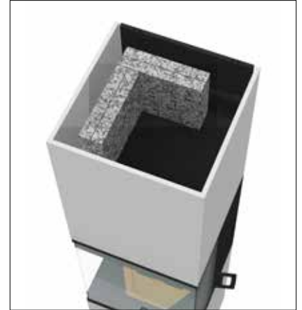
Vier Speicherplatten wie abgebildet positionieren.
