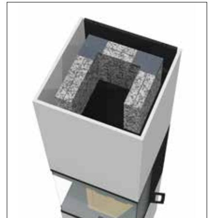
Speicherplatten mit einem Eckwinkel sichern.
