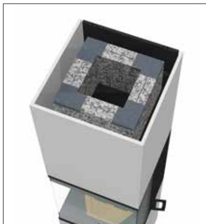
Speicherplatten mit letzten zwei Eckwinkeln sichern.
