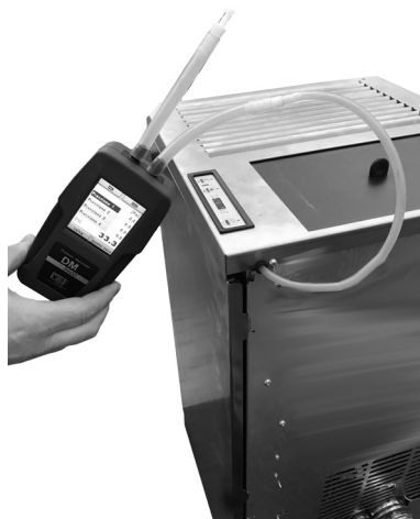
Fig. 62 - Anschluss des Digitaldruckwächters
