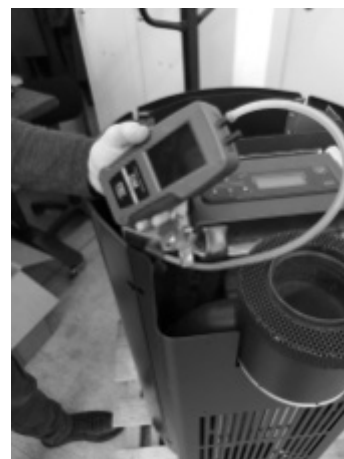
Fig. 63 - Anschluss des Digitaldruckwächters
