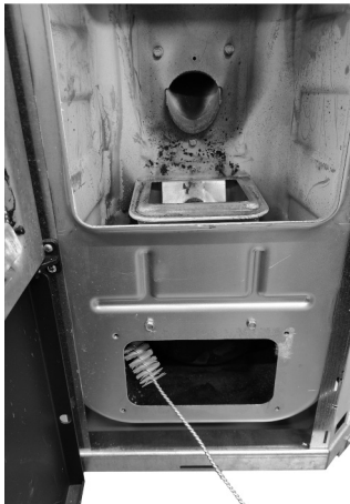
Fig. 70 - Mit einer Rohrreinigungsbürste reinigen
