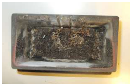
BEISPIEL VERSCHMUTZTE BRENNSCHALE
