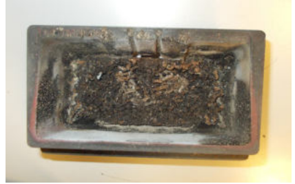
BEISPIEL VERSCHMUTZTE BRENNSCHALE
