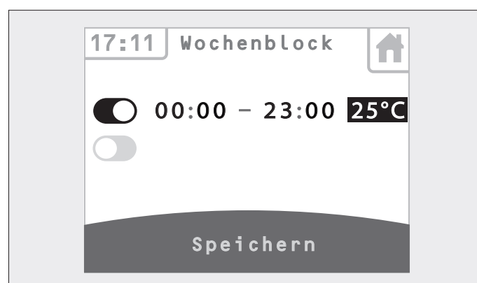
Abb. 3.26 Touch-Bedienfeld – Schaltzeiten einstellen
