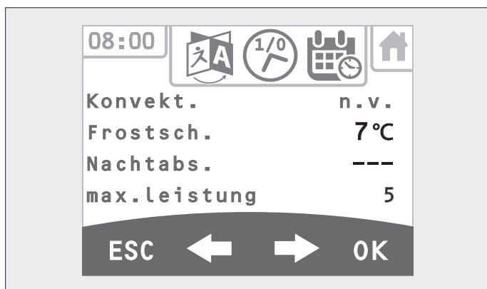
Abb. 3.18 Touch-Bedienfeld – Wert mit Pfeiltasten verstellen
