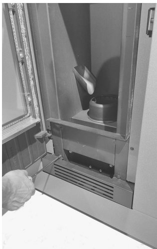
Fig. 49 - Entfernen Sie die LUCE Maske
