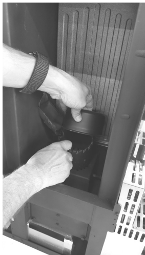
Fig. 47 - Die Brennschale entfernen
