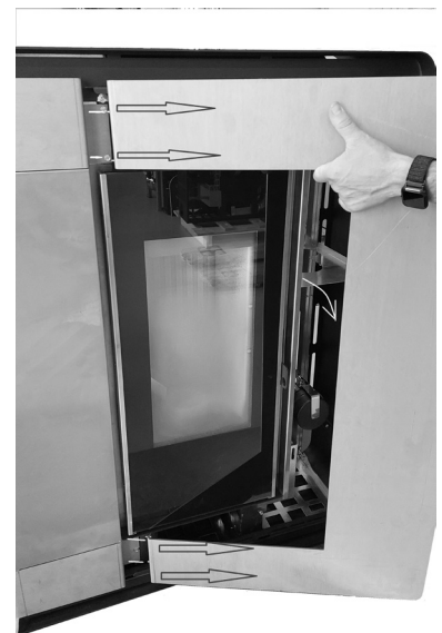
Fig. 23 - Entfernen des Rahmens
