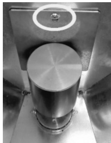
Fig. 64 - Entfernen der Schraube
