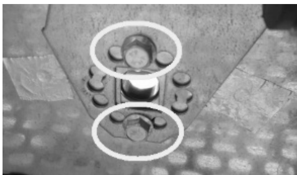
Fig. 63 - Die Schrauben entfernen
