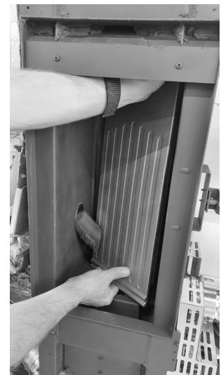
Fig. 57 - Entfernen Sie die Rückseite des Herdes 2
