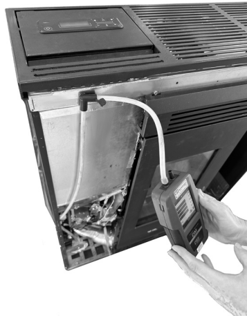
Fig. 46 - Anschluss für digitalen Druckschalter
