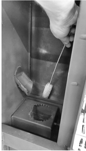
Fig. 58 - Mit einer Rohrreinigungsbürste reinigen
