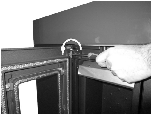
Fig. 24 - Entfernen der Schrauben
