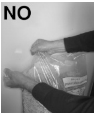
Fig. 13 - Fehlerhafte Öffnung des Pelletsacks
