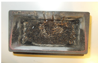
BEISPIEL VERSCHMUTZTE BRENNSCHALE
