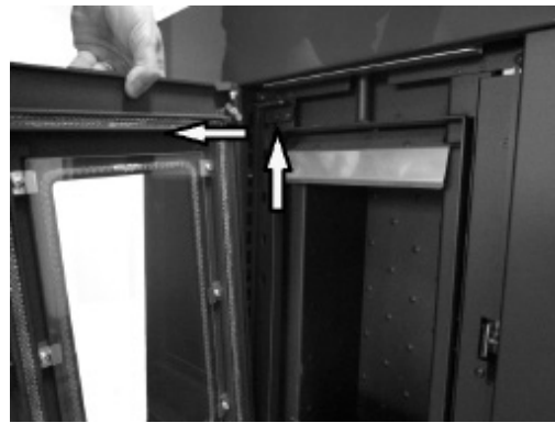
Fig. 19 - Ausbau der Tür
