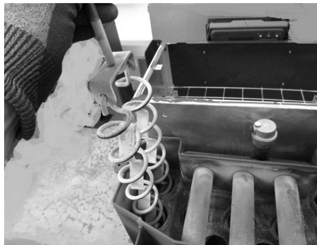
Fig. 93 - Austausch der Turbulatoren, wenn erforderlich
