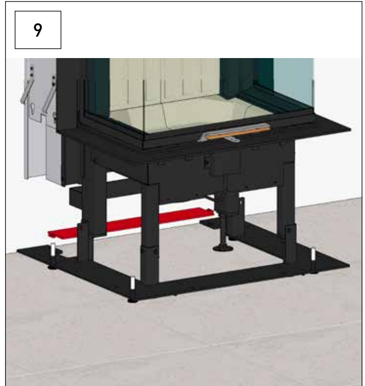
9 Sockelplatte Einleger montieren.
