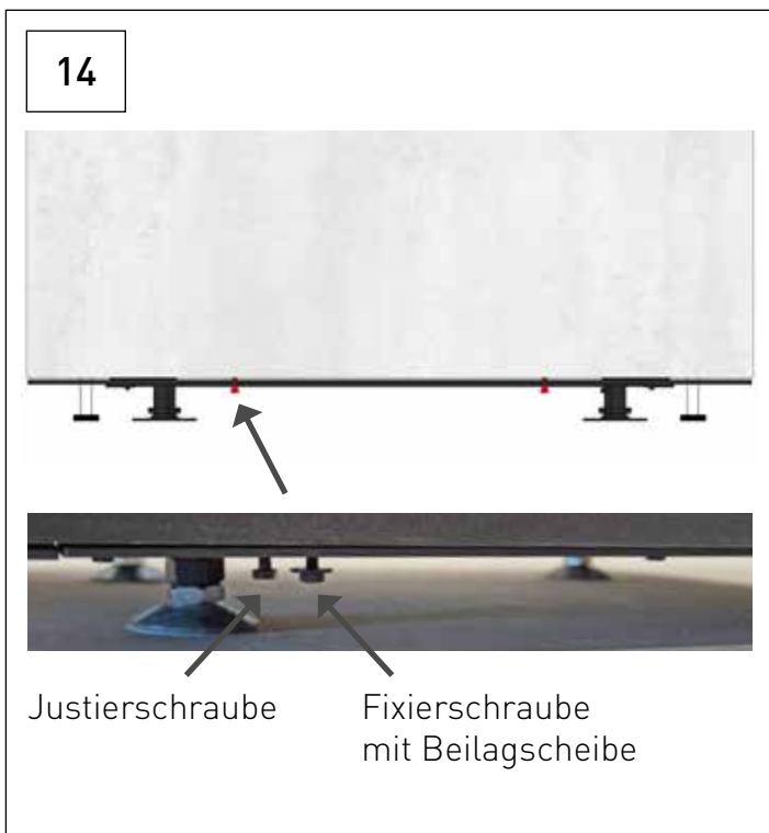
Sockelelement fixieren aber noch nicht festschrauben.
