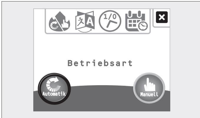
Abb. 3.22 Touch-Bedienfeld – Betriebsart Manuell
