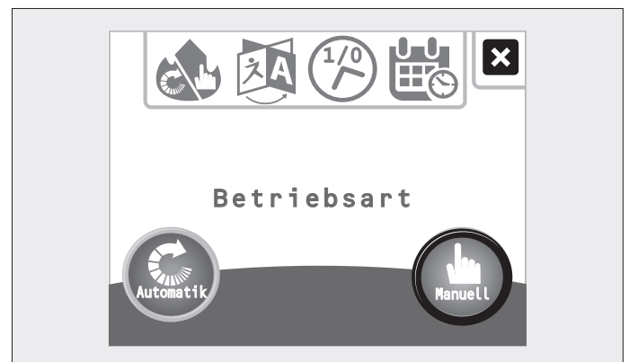
Abb. 3.21 Touch-Bedienfeld – Betriebsart Manuell
