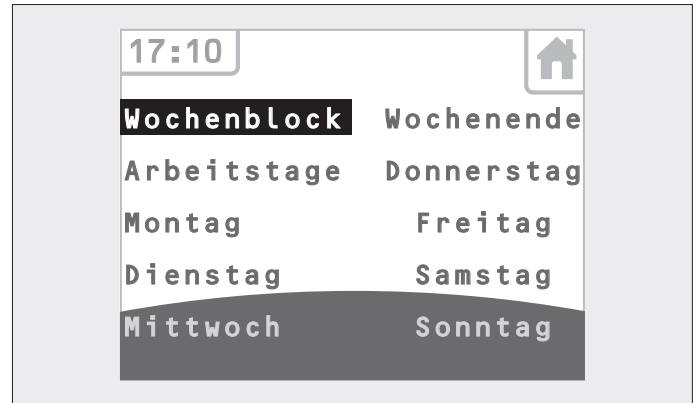
Abb. 3.24 Touch-Bedienfeld – Schaltzeiten, vordefinierte Tagesblöcke
