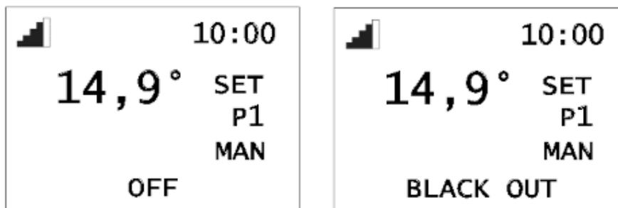
Beim Ausschalten aufgrund eines **STROMAUSFALLS** zeigt das Display abwechselnd die Anzeigen „Black-Out“ und „OFF“ an.
