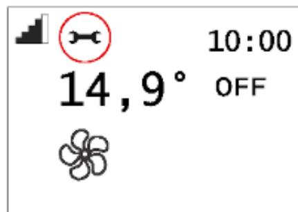
Nach 2000 Betriebsstunden erscheint auf der Anzeige das Symbol eines „Schraubenschlüssels“
