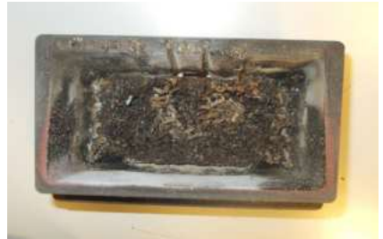
BEISPIEL VERSCHMUTZTE BRENNSCHALE
