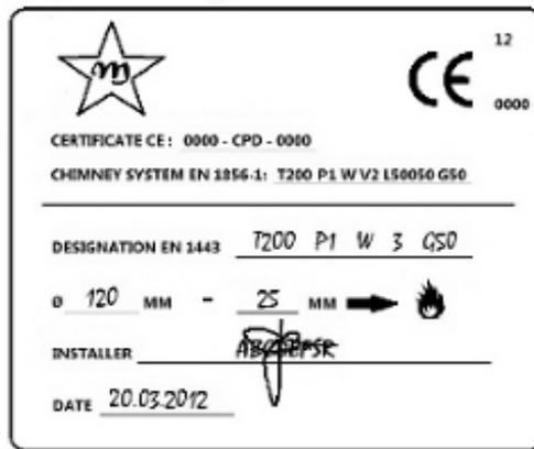
Fig. 3 - Beispiel für Typenschild
