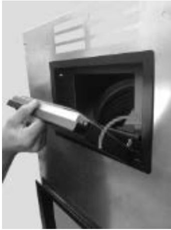
Fig. 66 - Tür in die Ladeklappe fügen
