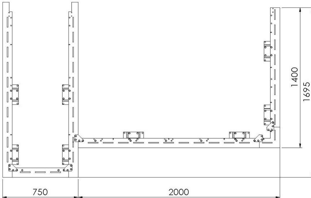
Sockelrahmen mit Seitenelement Aufbau 750 mm links:
