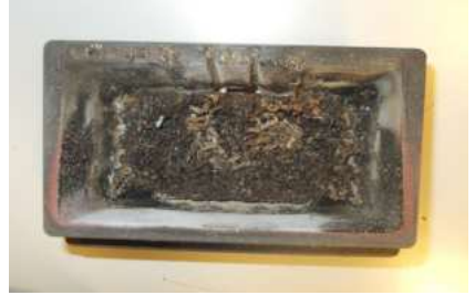
BEISPIEL VERSCHMUTZTE BRENNSCHALE
